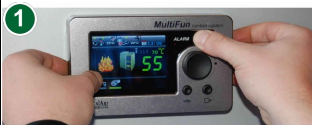
1 Podważyć ramkę, aby puścić zatrzaski
